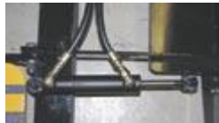
Гидравлический подъем скребков
