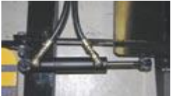
Гидравлический подъем скребков
